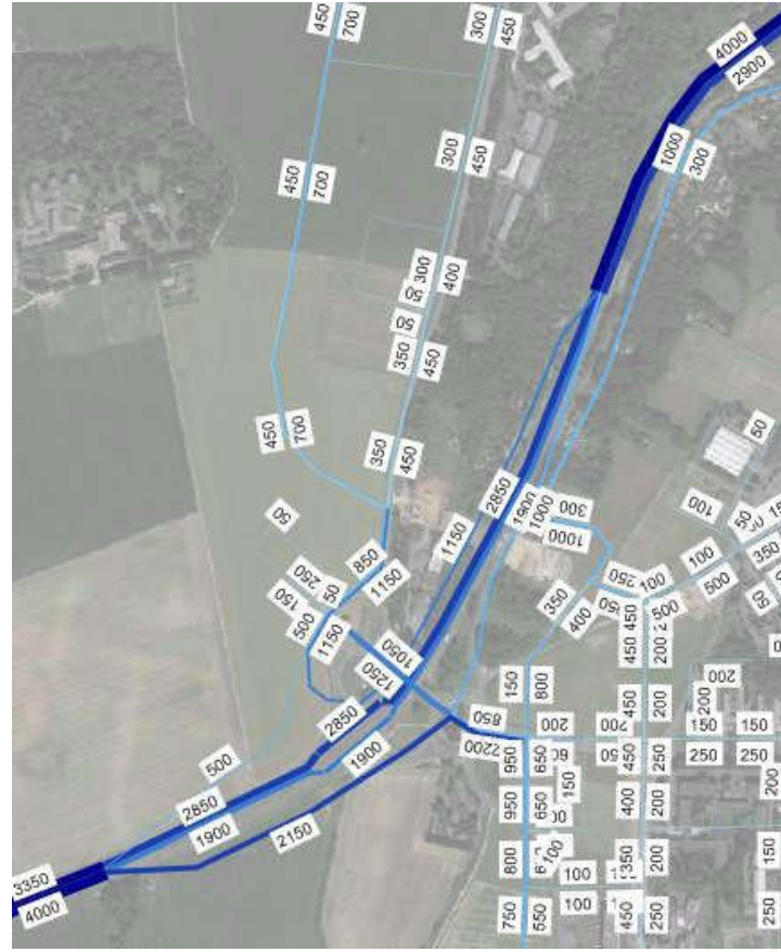
Figure 134. Flux en vvp/h à l'HPM à long terme – après écrêtage des flux
